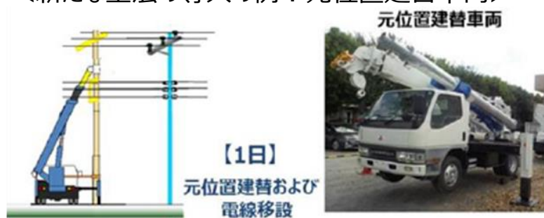
＜新たな工法の導入の例：元位置建替車両＞
