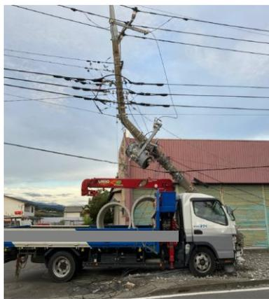
自動車衝突による電柱損壊
