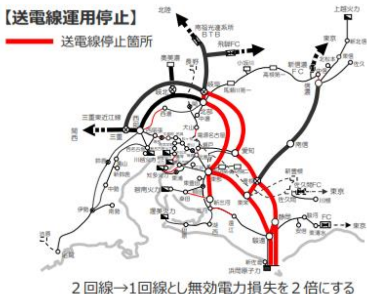
図 18 配電ネットワークの無効電力が上位系統に与える影響
