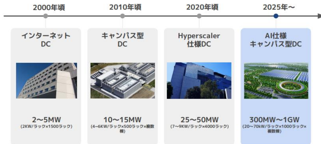
図 1 - 7 データセンター拠点の電力容量の推移
