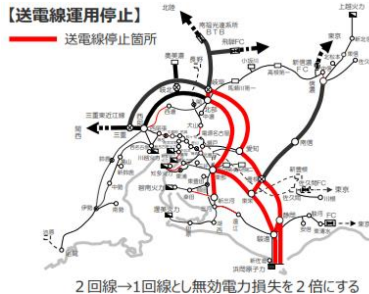
図 2 - 7 配電ネットワークの無効電力が上位系統に与える影響
