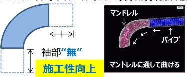
※1:直接加熱することなく(非接触)、パイプを温めて曲げる、※2:3DR=エルボの曲率半径(3×D[口径]のR[曲率半径])
