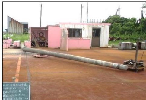
写真：曲げ破壊試験の様子
