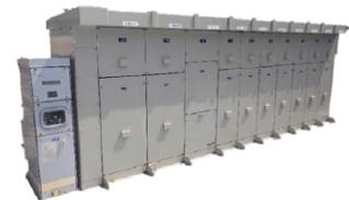
※SIS：固体絶縁開閉装置（Solid Insulated Switchgear）。充電部をエポキシ樹脂で絶縁し、表面を接地層でおおった完全固体絶縁方式によりコンパクト化した開閉装置。変電所において配電線の電力供給、事故時の迅速復旧の役割を担う。
