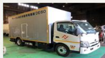
高圧移動発電機車
