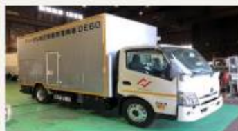
高圧移動発電機車
