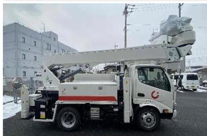
ブームの先端に作業用バケットがあり、高所で作業ができる車両です。配電線工事のほか、倒木などの伐採においても使用することや、変圧器等の重量物の吊上げも可能です
