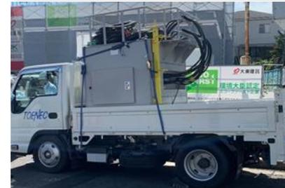
車両後部に変圧器が積載されており、変圧器以下の仮送電が可能で、変圧器取替工事を無停電で実施する際に使用します
