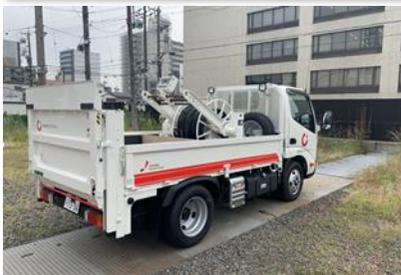
車両後部に電線の巻取機が積載されており、複数径間における電線張替や新設工事にて、効率よく電線を引き抜くことができ、効率よく作業が可能になります
