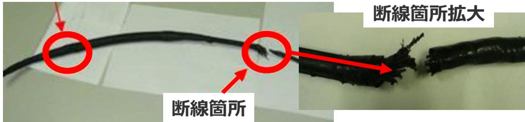
電線接続箇所の劣化
