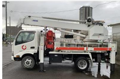
折損した電柱や倒木を吊るクレーン車です。車両にはサブブームがあり、折損柱と折損復旧用ポールの同時吊上げができ、折損復旧が可能です
