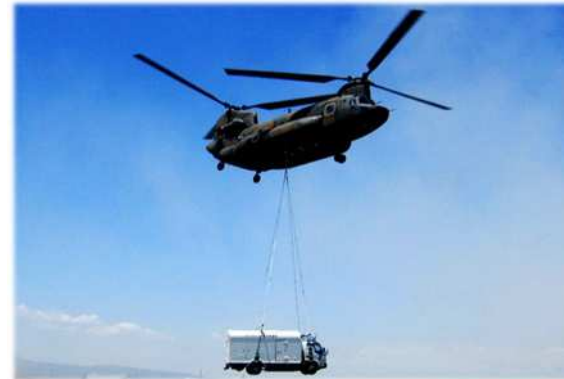
自衛隊ヘリによる 高圧発電機車の空輸訓練
