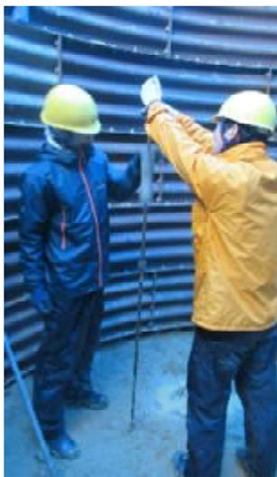
5kgの錘を高さ50cmから落下させ、10cm貫入に要する回数を求める試験
